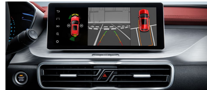
Caméra 360° haute résolution avec ligne de guidage dynamique et 4 radars arrières.
